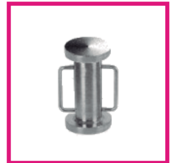
ADITAMENTO PARA PRUEBAS DE CUBOS PARA PRENSA DE 120 ton.
