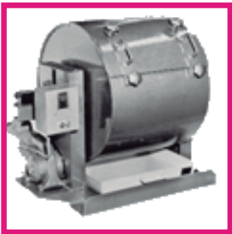
MAQUINA DE ABRASIÓN DE LOS ANGELES, EQUIPADA CON MOTOR DE 1.5 HP Y CUENTA VUELTAS DE PARO AUTOMÁTICO
