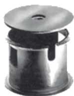
CAMISA DE ASBESTO PARA EQUIPO DE DESTILACIÓN DE ASFALTOS
