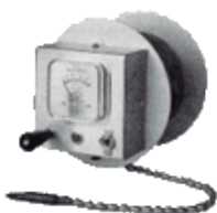
SONDA PARA CHECAR LA PROFUNDIDAD DEL ESPEJO DEL AGUA
