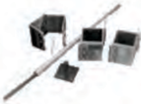
EQUIPO PARA VALOR CEMENTANTE COMPUESTO DE: 3 MOLDES, GUÍA, PIZÓN Y PLACA DE CARGA
