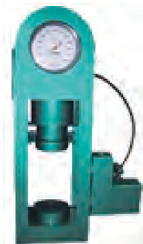
PRENSA DE 120 TON COMPRESIÓN Y FLEXION
