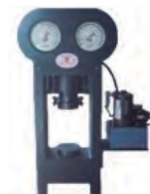
PRENSA HIDRAULICA DE OPERACIÓN ELÉCTRICA CON DOS MANÓMETROS DE 20 TON Y 120 TON
