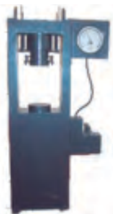
PRENSA DE 120 TON COMPRESIÓN Y FLEXION
