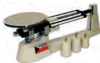
BALANZA DE 2,610 gr. DE CAPACIDAD TRIPLE BARRA MCA. OHAUS sensibilidad de 0.1 gr. con cucharón y pesas.
